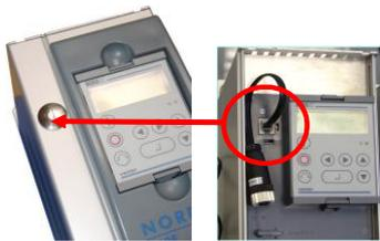
RS232 / RJ12 „onboard“ BG 5 - 8 (Standard)
