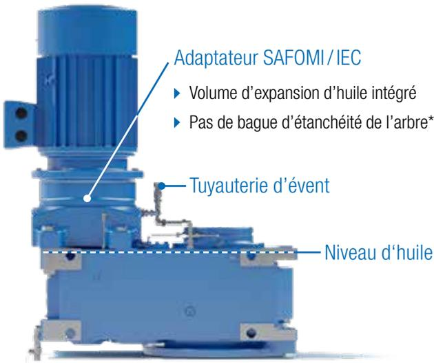
\* En combinaison avec l'adaptateur SAFOMI/IEC, l'utilisation d'un moteur étanche à l'huile est nécessaire.
