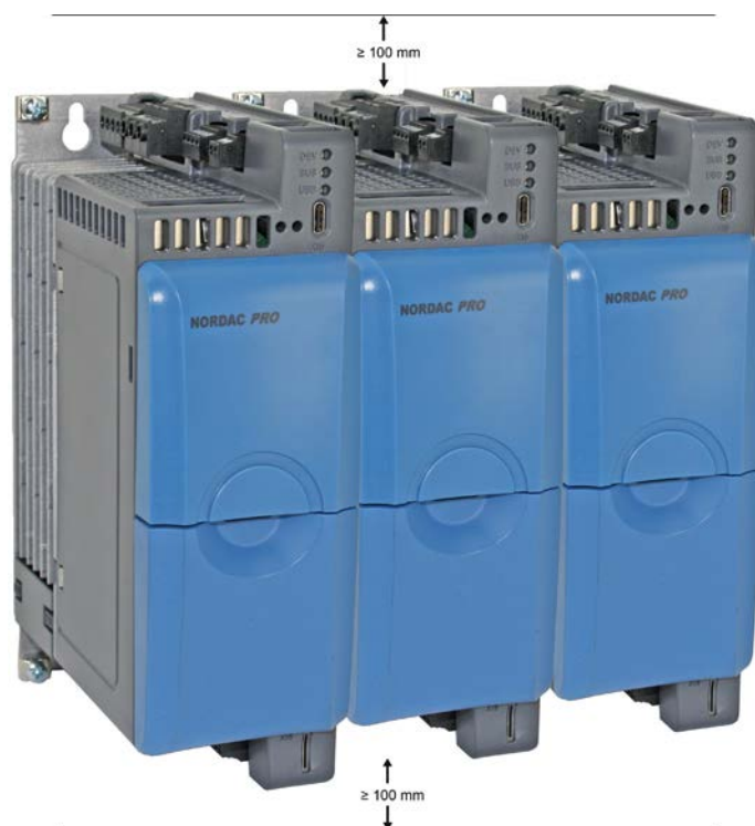
Рисунок 1: Монтажные расстояния
