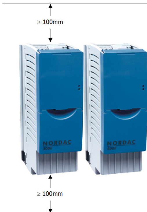
Abbildung 1: Montageabstände SK 5xxE
