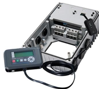
Nach Abschluss der Inbetriebnahme ist die Spannungsversorgung erneut abzuschalten und das Gerät wieder korrekt zu verschließen (Gehäusedeckel, Diagnoseverschlüsse und Kabeldurchführungen), um die Betriebssicherheit und den IP-Schutzgrad wiederherzustellen.
