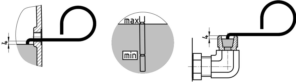
الشكل 27: فحص مستوى الزيت بواسطة مقياس عمق الزيت
