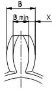
الشكل 29: قياس سماكة السن بالنسبة للقابض الكلابي ROTEX®
