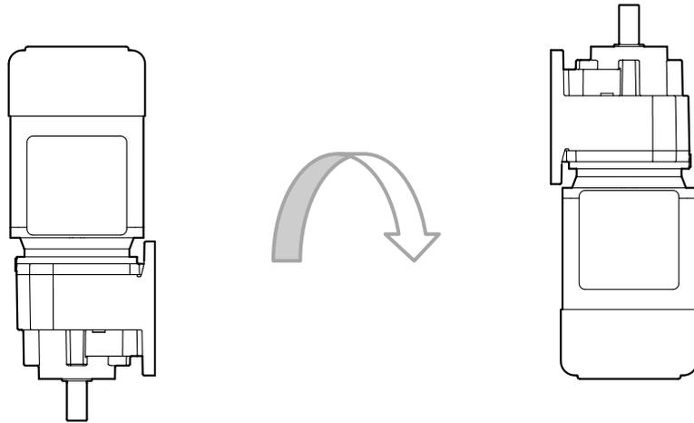
الشكل 33: قياس مستوى الزيت SK 072.1 – SK 172.1
