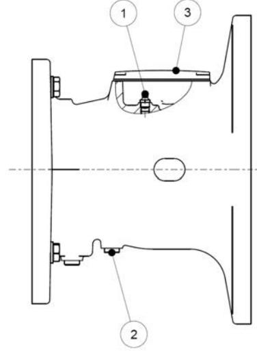
الشكل 31: إعادة تشحيم المهايئات المطابقة لمعايير اللجنة الكهروتقنية الدولية/لمعايير الجمعية الوطنية لمصنعي الأجهزة الكهربائية AI و AN خيار BRG1
