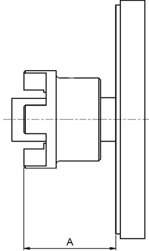
جدول 8: وضع الوصلة النصفية على عمود المحرك المطابق لمعايير الجمعية الوطنية لمصنعي الأجهزة الكهربائية
