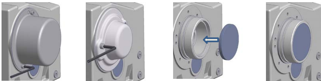
Slika 14: montaža pokrivnog poklopca opcije SH, H i H66
