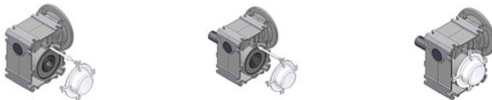
Slika 15: demontaža i montaža pokrivne kapice
