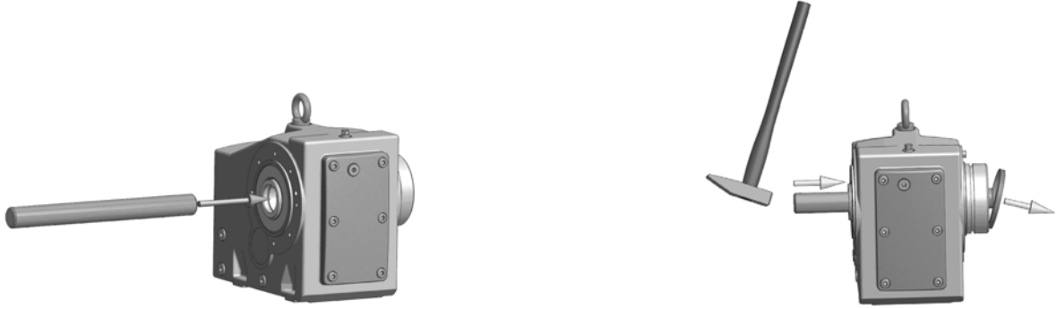
Şekil 5: Fabrikada takılan kilit başlığının sökülmesi
