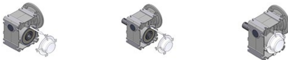
Slika 15: Demontaža i montaža pokrovne kape
