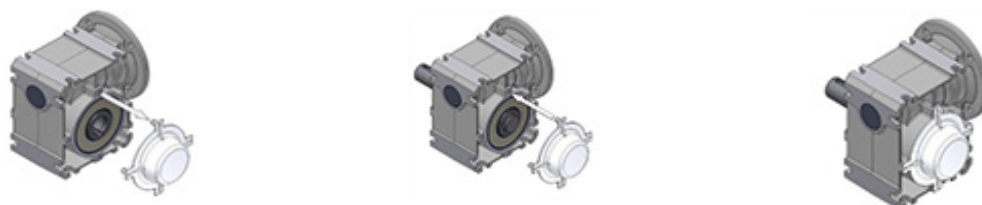
Bild 15: Demontera och montera skyddskåpa
