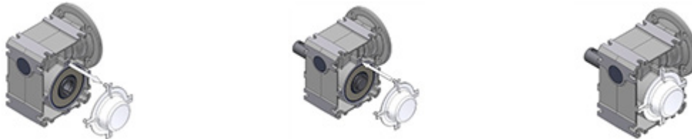
Abbildung 15: Demontage und Montage der Abdeckkappe
