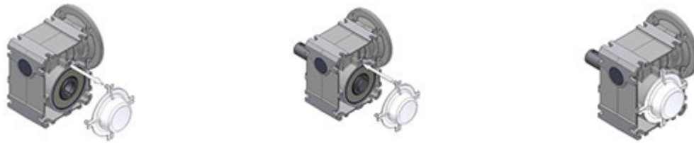
그림 14: 커버 캡 분해 및 설치 방법
