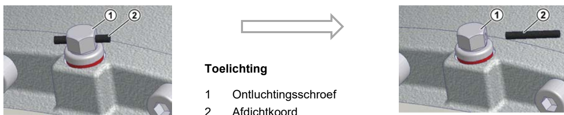
Afbeelding 20: Activeren van de ontluchtingsschroef
