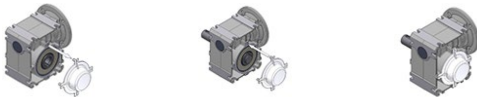
Afbeelding 14: Demontage en montage van de afdekkap
