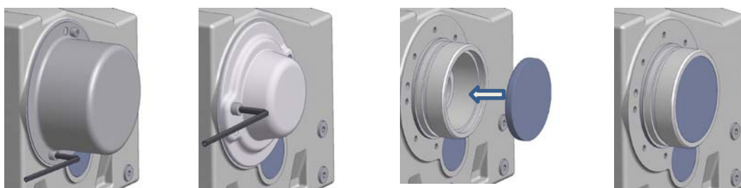
Figure 13 : Montage du capot de protection option SH, option H et option H66
